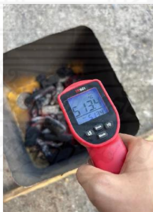
ภาพที่ 5 การวัดค่าอุณหภูมิความร้อนของถ่านขณะเผาไหม้
